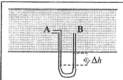
En el ejemplo que sigue a continuación vamos a demostrar que la diferencia de nivel en el líquido manométrico dentro de la U permite calcular la velocidad del fluido dentro del tubo.
