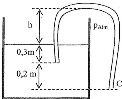
6) Se llena una manguera de pequeño diámetro: 1 cm (constante) con nafta y se cierra por sus dos extremos. Se introduce un extremo en un depósito de nafta de gran diámetro, venteado a la atmósfera. Las posiciones de los extremos de la manguera y de la superficie libre en el depósito se indican en la figura. Se abren ambos extremos. La densidad relativa de la nafta es 0,68.
