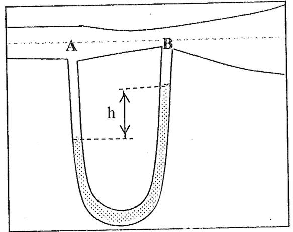
Se le agregó abajo un tubo en “U”, y como la presión en las dos secciones que comunica no es la misma, el nivel del líquido (mercurio) dentro del tubo no es el mismo.
